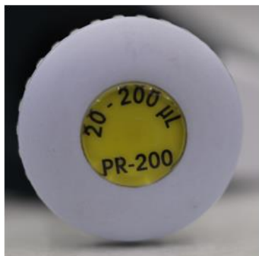
P200: pot transferir entre 20 i 200 \mu\text{L}
