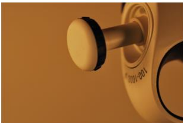
Aquesta pipeta només es pot fer servir per transferir volums des de 100 µL, com a mínim i fins a 1000 µL, com màxim
